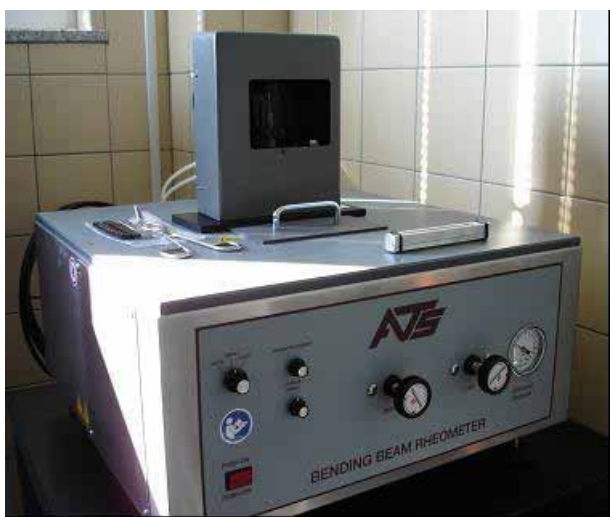
Slika 4. Aparatura (BBR) za određivanje karakteristika bitumena koje pokazuju njegovu otpornost prema pukotinama (niske temperature)
