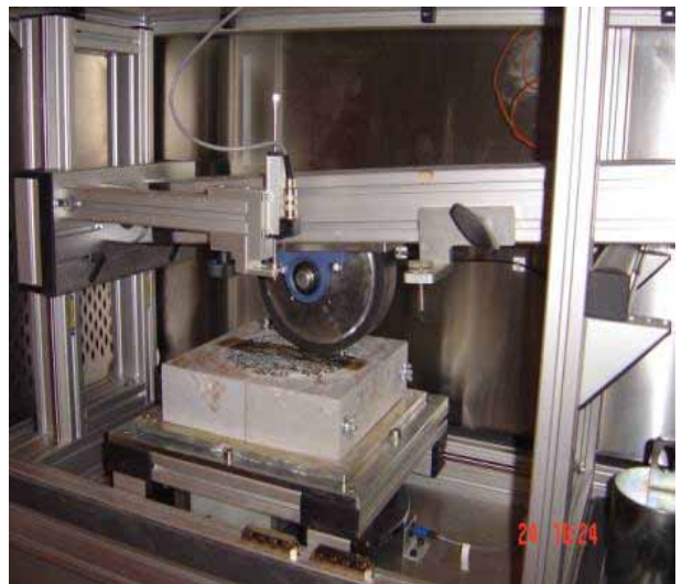
Slika 7. Aparat za ispitivanje otpornosti asfalta prema kolotražanju (HRN EN 12697-22)
