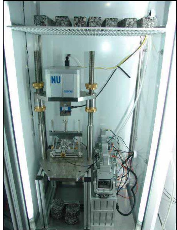
Slika 9. Aparat za ispitivanje otpornosti asfalta prema pojavi pukotina zamorom (HRN EN 12697-24)
