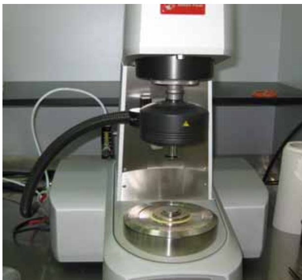
Slika 3. Aparatura (DSR) za određivanje karakteristika bitumena koje pokazuju njegovu otpornost prema kolotražnju i pukotinama (zamor)
