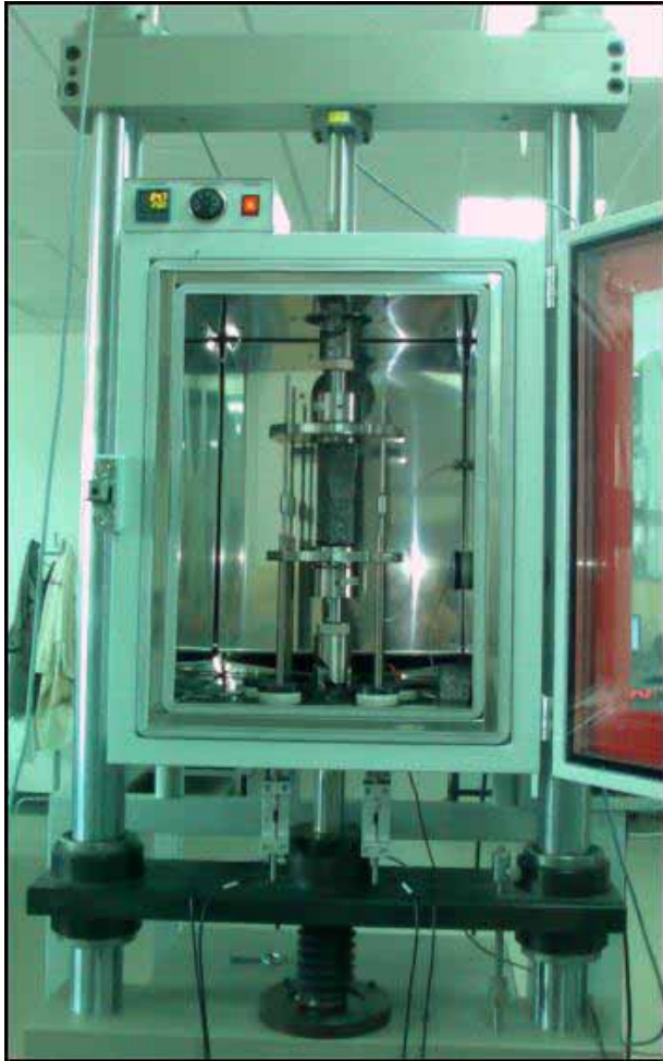
Slika 8. Aparat za ispitivanje otpornosti asfalta prema pojavi pukotina pri niskim temperaturama (PrEN 12697-46)
